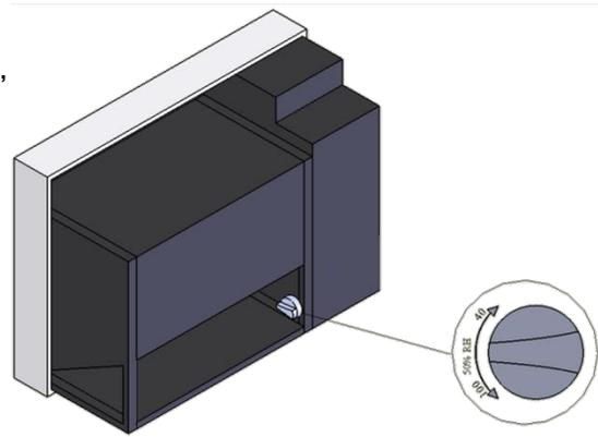
**Konstant måling af fugtighed** Dantherm anbefaler at man tilslutter en eksternt hygrostat for at sikre en konstant måling af fugtigheden i swimmingpoolområdet.
