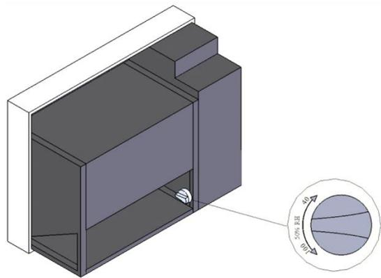
**Leitura constante da humidade** A Dantherm Air Handling recomenda o uso de higróstato externo de modo a garantir a medição constante da humidade relativa no espaço da piscina.
